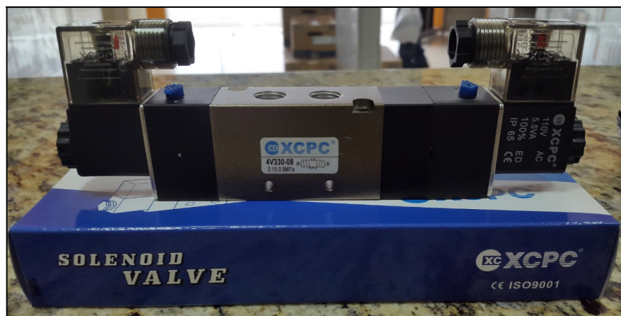
Figura 6. 7: Electroválvula 5/3 – 1/4" (120V.) Elaborado por: Autor
