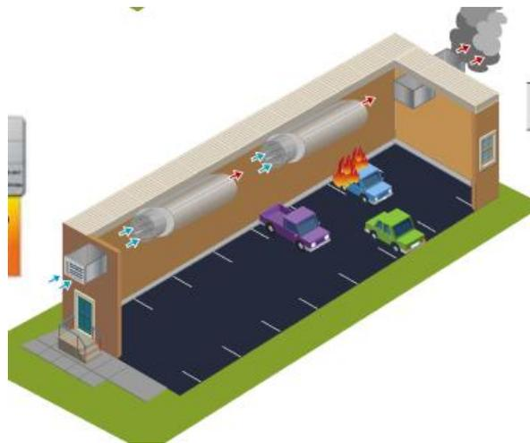
Figura 3.22. Extractores de humo en funcionamiento
