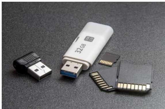
Figura 2.8: Ejemplos de memorias flash (USB y tarjetas SD)
