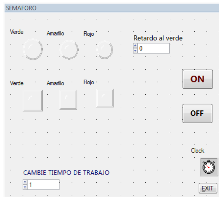
Figura 2.11: HMI realizado en LabWindows, programa que permite programar por GUI Elaborado por: Autor
