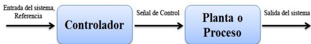
Figura 2.1: Diagrama de bloques del sistema básico de control de lazo abierto Elaborado por: Autor.
