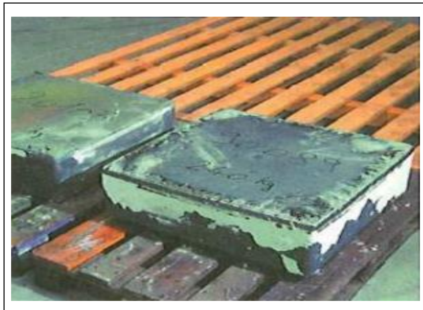
Figura 2.14 Solidificación de panel solar policristalino. Fuente: Montoya Rasero, Carlos (2017).
