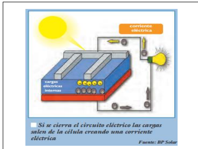
Figura 2.5 Flujo de corriente eléctrica en una célula fotovoltaica. Fuente: Pep Puig, Marta Jofra (2018).
