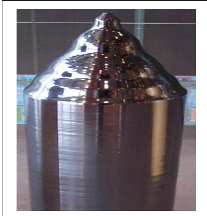
Figura 2.12 Lingote de silicio monocristalino. Fuente: Montoya Rasero, Carlos (2017).
