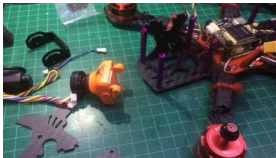
Figura 3. 16: Montaje de Cámara Runcam Owl II. Elaborado por: Autor
