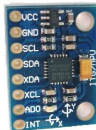
Figura 2. 33: Sensor acelerómetro. Fuente: (González, 2017).
