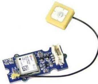
Figura 2. 32: Ejemplo de un sensor GPS. Fuente: (Alvarez, 2014).
