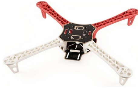
Figura 2. 24: Estructura de un dron cuadricóptero. Fuente: (Cortés, 2016).
