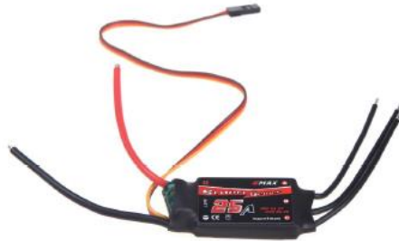
Figura 2. 30: Controlador electrónico de velocidad. Fuente:(Cortés, 2016).
