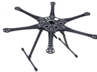
Figura 2. 25: Estructura de un hexacóptero. Fuente:(Abdus, Anwarul, Muhamunad, & Faisal, 2015).
