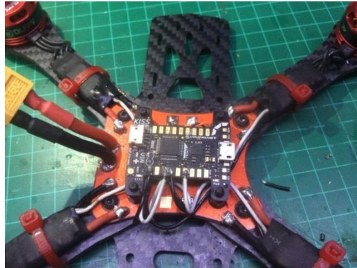
Figura 3. 13: Montaje de controladora de vuelo Kiss FC Elaborado por: Autor
