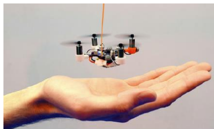
Figura 2. 16: Drone de escala muy pequeña capaz de aterrizar en una mano. Fuente: (Mulgaonkar et al., 2018).
