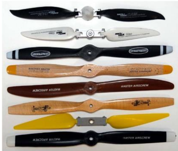
Figura 2. 20: Ejemplo de diferentes materiales puede ser hecho para una hélice. Fuente: (Benito, 2015).
