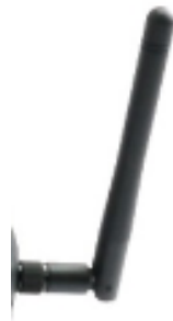
Figura 2. 13: Antena de polarización lineal, colocado en las gafas FPV. Fuente: (Crespo, 2014).
