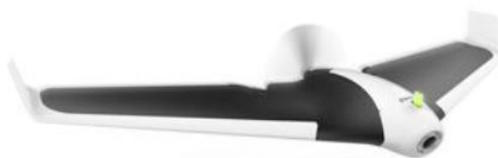
Figura 2. 8: Ala fija, modelo Parrot Disco FPV. Fuente: (Fisher, 2017).
