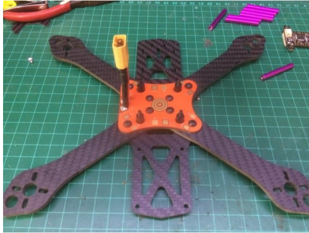
Figura 3. 11: Ensamblaje de base e instalación de PDB Elaborado por: Autor
