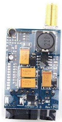
Figura 2. 11: Ejemplo de un transmisor de video. Fuente: (Aiju, 2017).
