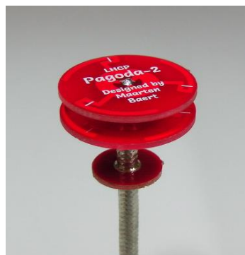
Figura 2. 14: Antena Pagoda diseñado por Maarten Baert. Fuente: (Baert, 2016).
