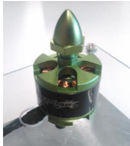
Figura 2. 27: Ejemplo de un motor sin escobillas. Fuente: (Pérez & Corres, 2015).
