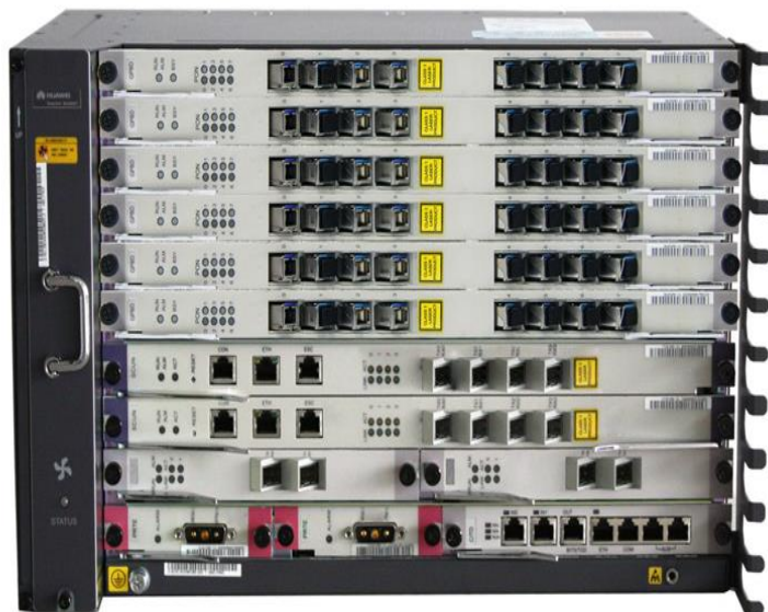
Figura 2.9: Terminal de línea óptica
