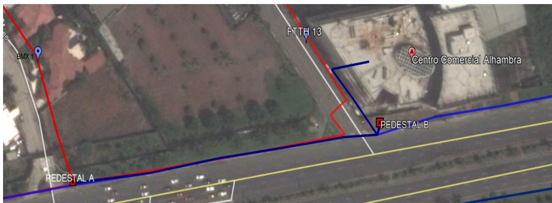
Figura 3.10: Pedestales A y B alimentando el nodo del centro comercial
