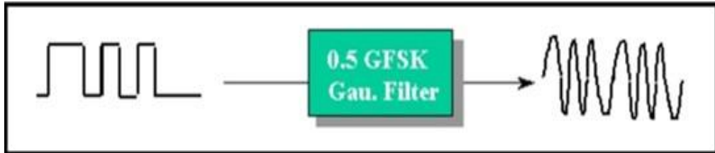
Figura 3.15: Principio del filtro gaussiano sobre la banda base. Fuente: ("GFSK modulation - Near Communications", 2018)
