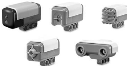
Figura 2.8: Diferentes sensores de LEGO, sensores de tacto, luz y sonido. Fuente: (Zabala, 2007)
