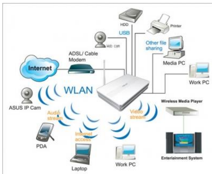
Fig. 2. 7: Topología de una red WLAN.
