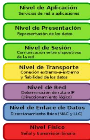
Fig. 2. 3: Modelo de interconexión de sistemas abiertos.
