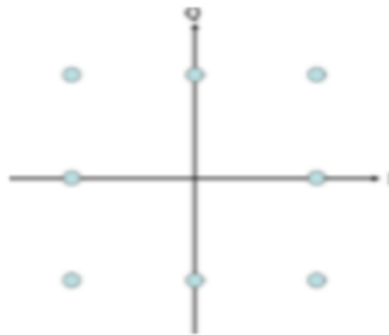
Figura 3. 2 : Diagrama de la constelación para 8-QAM Fuente: (Arora et al., 2012)
