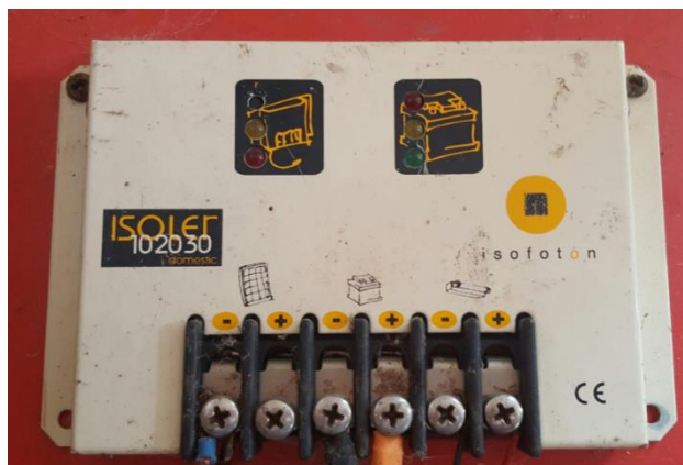
Figura 3. 12: Panel solar y controlador de carga utilizado Elaborado por: El Autor
