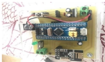
Figura 35. Tarjeta electrónica del bloque de iluminación. Fuente: Elaboración propia.
