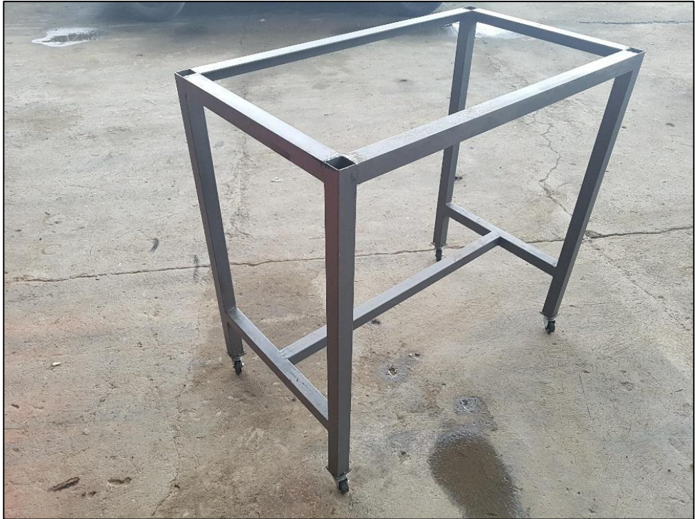
Anexo 1. Culminación de ensamblaje del soporte de la mesa Elaborado por: Autor
