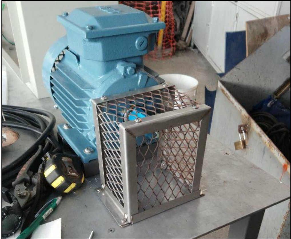
Anexo 33. Fijación de la guarda protectora. Elaborado por: Autor
