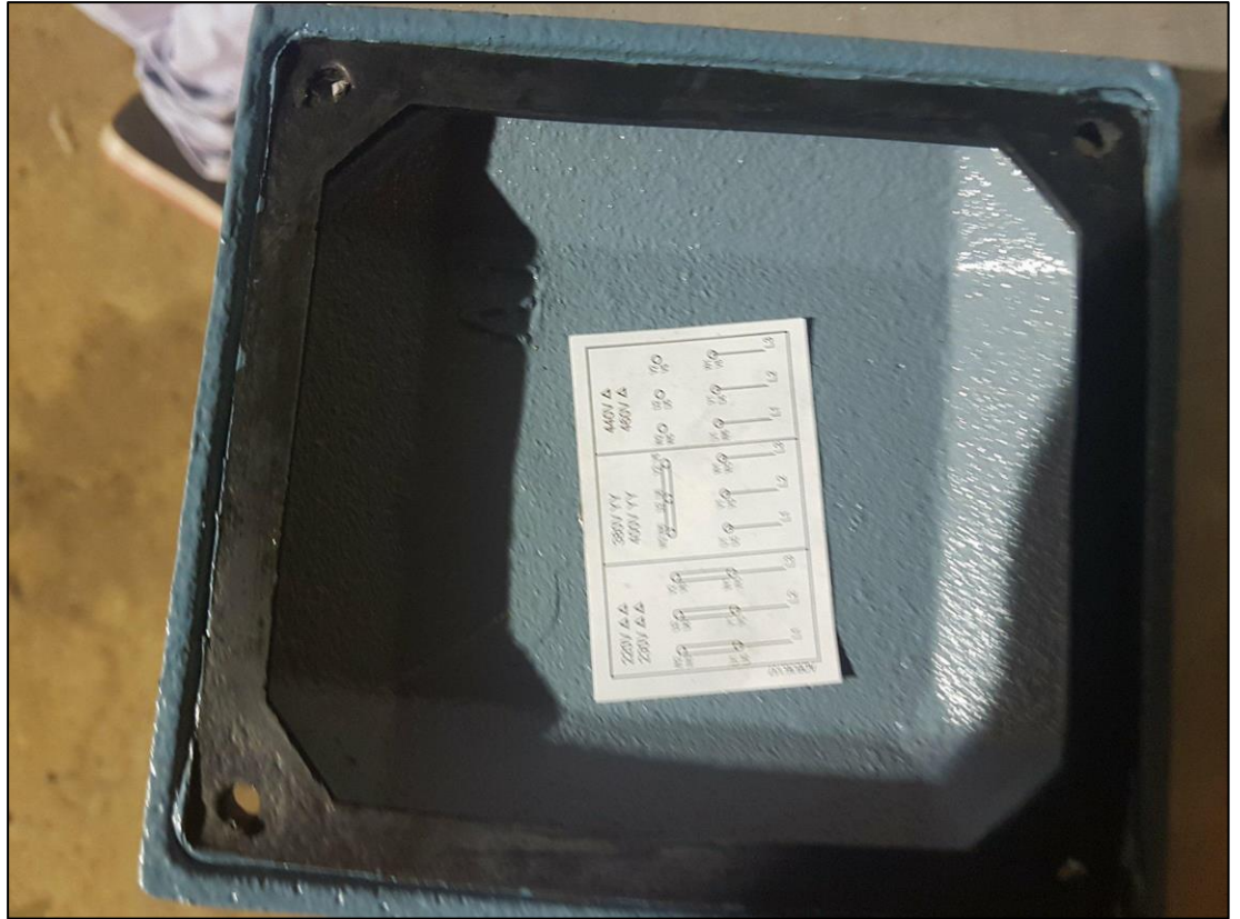
Anexo 21. Diagrama de conexiones interno del motor. Elaborado por: Autor
