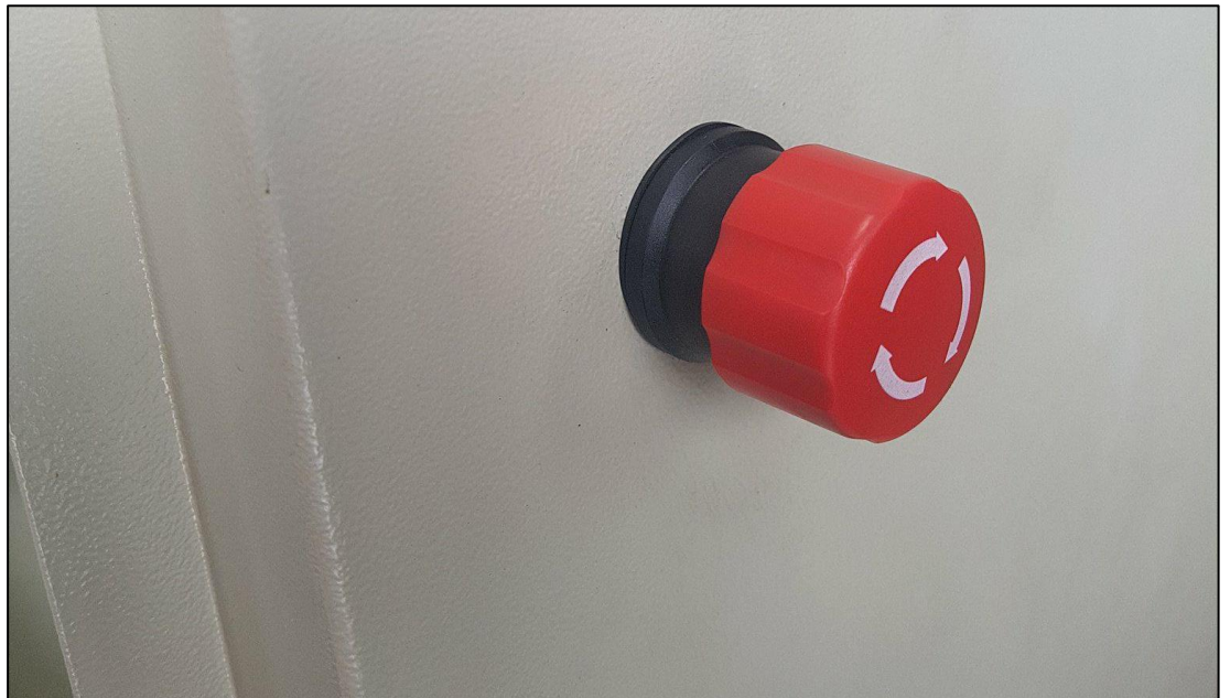
Anexo 16. Fijación del motor de paro de emergencia al costado lateral derecho Elaborado por: Autor
