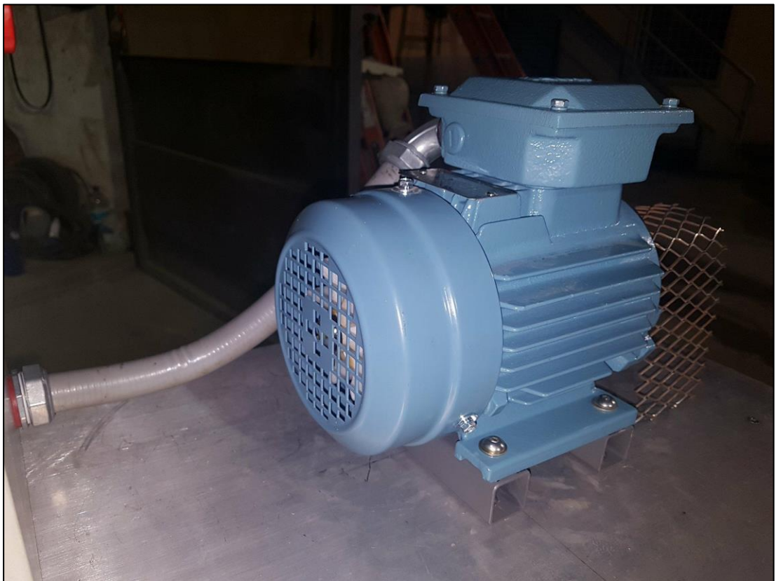
Anexo 40. Motor fijado a la mesa Elaborado por: Autor
