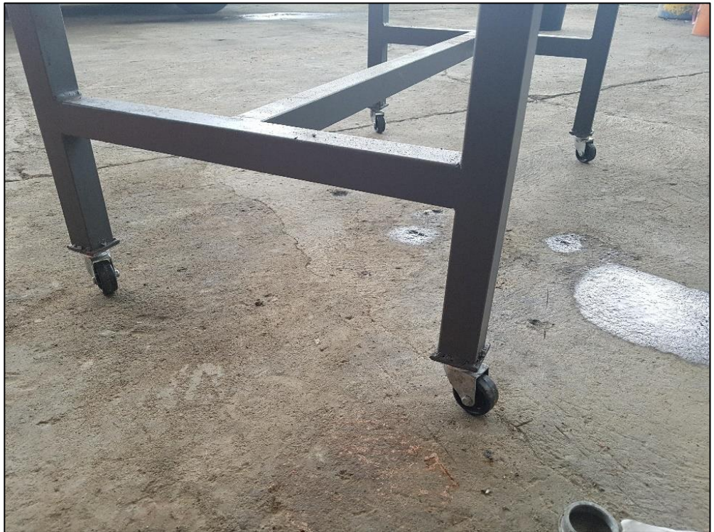
Anexo 2. Fijación de las ruedas del soporte de la mesa Elaborado por: Autor
