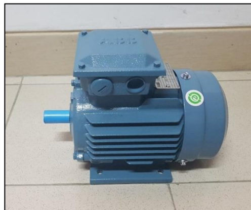
Figura 5. 3: Motor trifásico ABB Elaborado por: Autor
