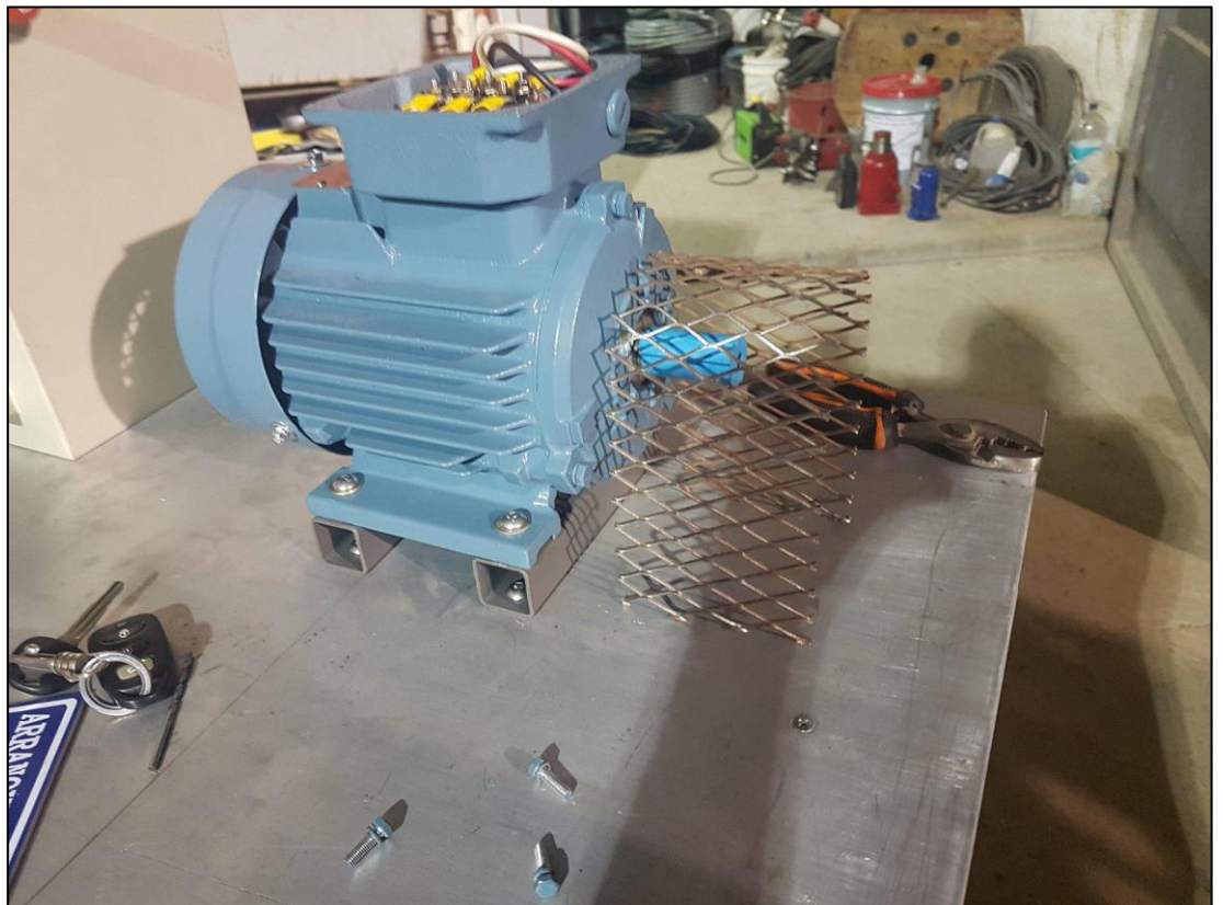
Anexo 32. Molde de malla para la guarda Elaborado por: Autor
