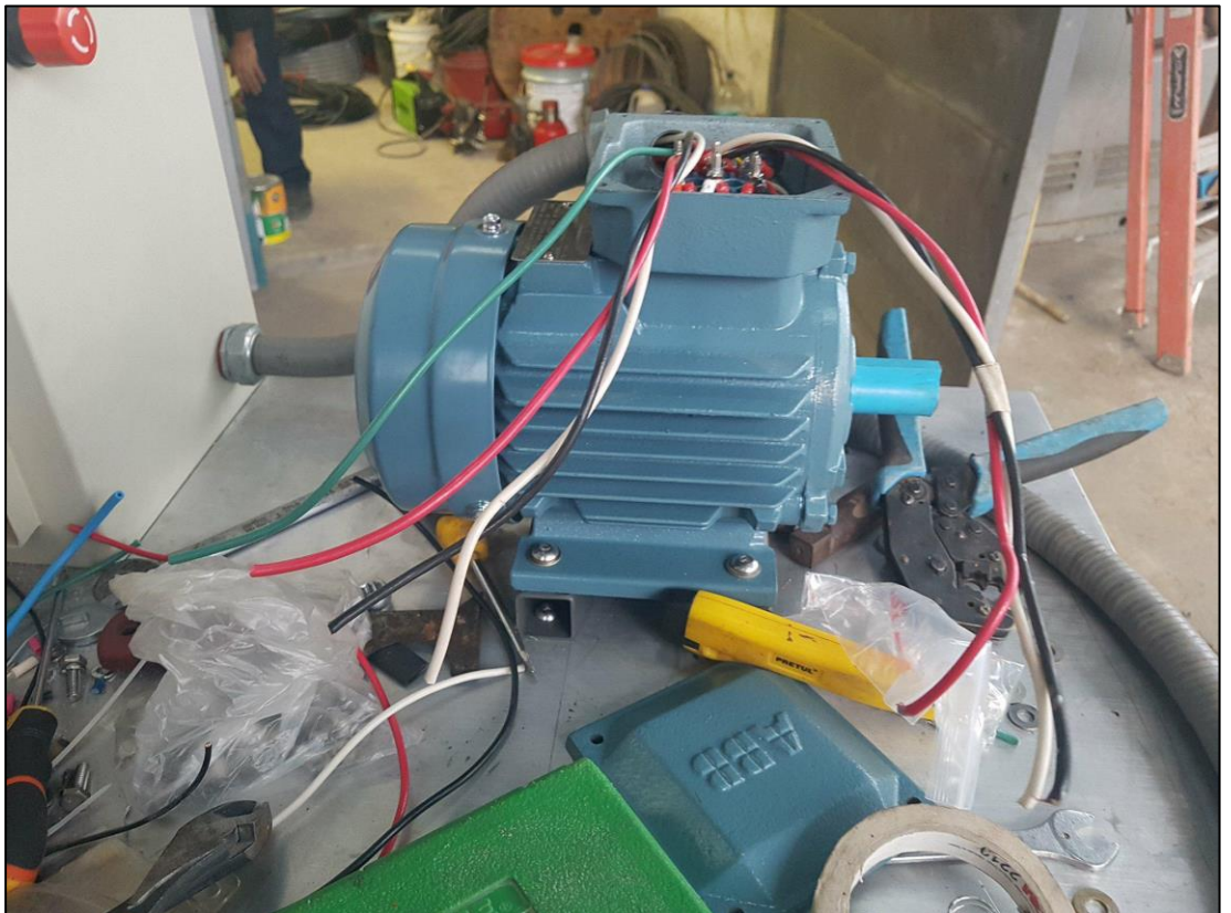
Anexo 20. Instalación de la funda sellada del tablero al motor Elaborado por: Autor
