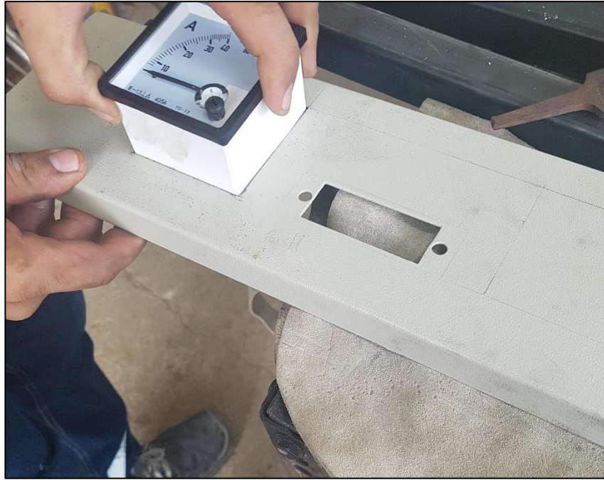
Anexo 7. Colocación de los equipos de medición Elaborado por: Autor
