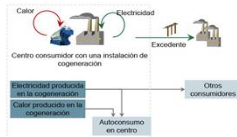
Figura 2.36. Producción de energía por el sistema de cogeneración Fuente: (Boston Consulting Group, 2010)
