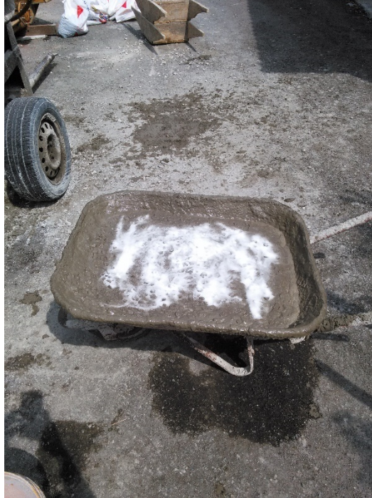
Figura 51: Sal agregada en hormigón para losetas 9 y 10
