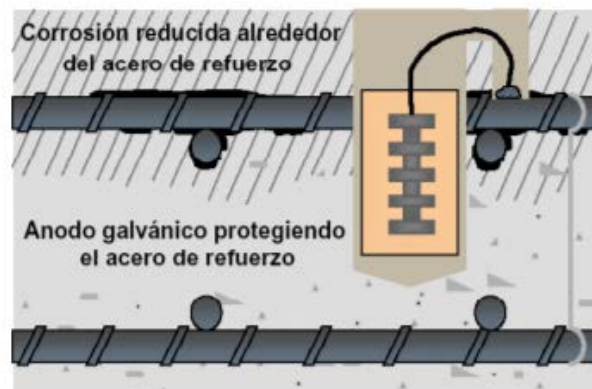
Ilustración 1: Instalación de los ánodos galvánicos realizada en el presente trabajo de titulación
