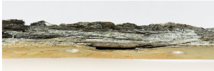
Figura 7: Corrosión por exfoliación en aluminio
