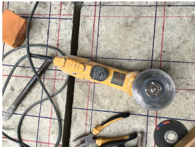
Figura 32: Amoladora utilizada en la instalación de los ánodos
