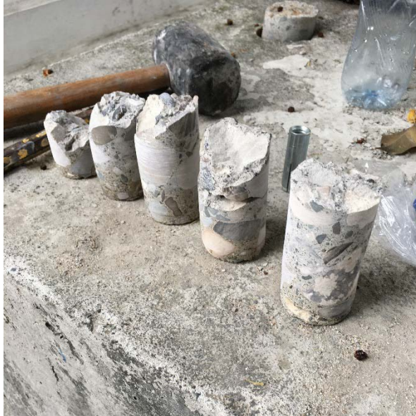
Figura 30: Núcleos extraídos de las losetas
