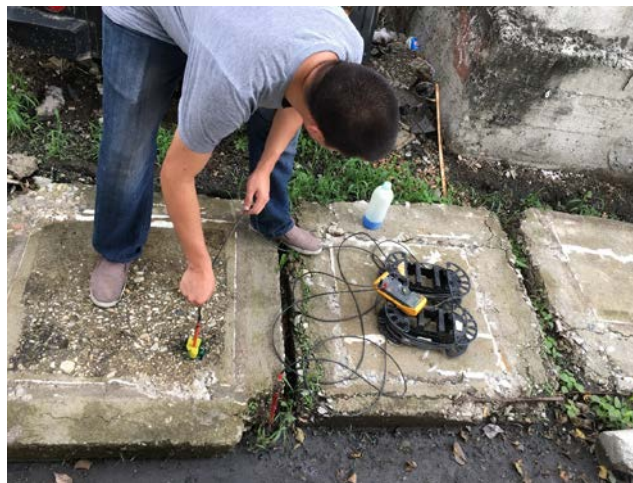
Figura 24: Medición del potencial de corrosión
