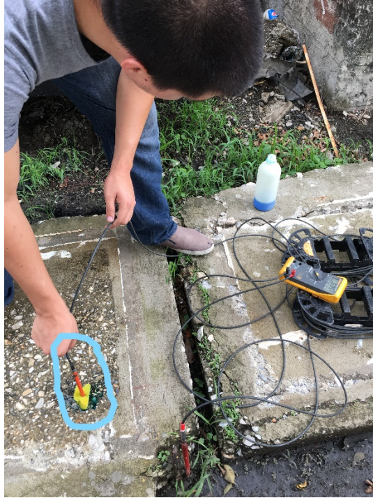
Gráfica 1 Medición del potencial de corrosión con Galvapulse
