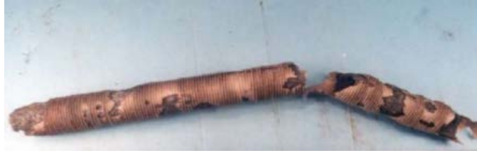
Figura 8: Corrosión por ataque selectivo
