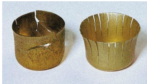
Figura 5: Corrosión por agrietamiento
