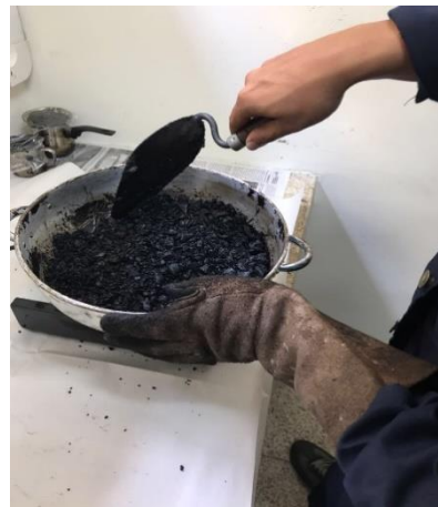
Figura 3. 2 Mezclado de agregado y ligante asfáltico
