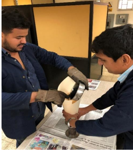
Figura 3. 3 Relleno de moldes de mezcla asfáltica
