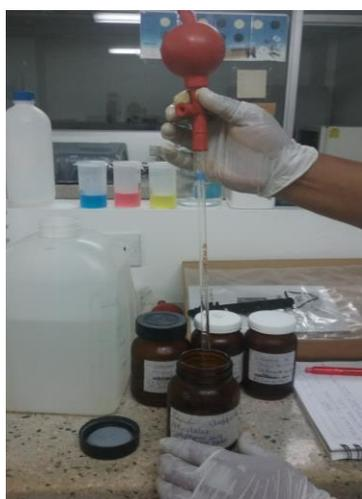
**Fotografía 42** Se agregan los 3,6 ml de los 4 reactivos en 3600 ml de Agua destilada a 20°C.
