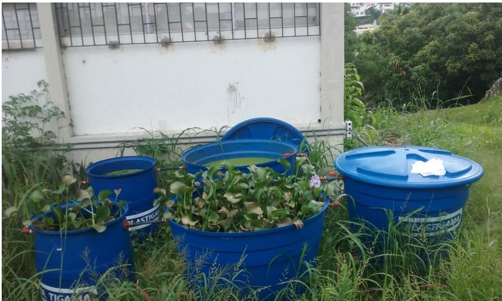
**Fotografía 93 Vista Lateral de la planta piloto en donde se aprecia un tanque total cubierto en su superficie de lechuga de agua y el subsiguiente solo parcialmente cubierto.**
