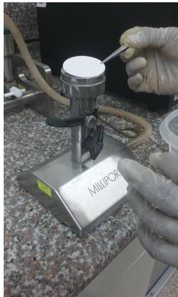
**Fotografía 53** El filtro se lo coloca con la cara lisa por debajo de la superficie de la máquina de filtración Millipore
