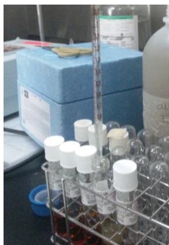
**Fotografía 49 Se agregan a los viales 2 ml de cada una de las 4 muestras y para el Blanco en cambio 2 ml de agua destilada. Esa mezcla debe ser homogénea y debe agitarse para que se disuelva.**
