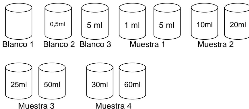
En sí, las 11 botellas deben estar diluidas hasta el borde con el agua destilada a  $20 \pm 3^\circ\text{C}$  mezclada con los 4 reactivos y aireada, una vez se le haya adherido la muestra en ml correspondiente a cada una.
