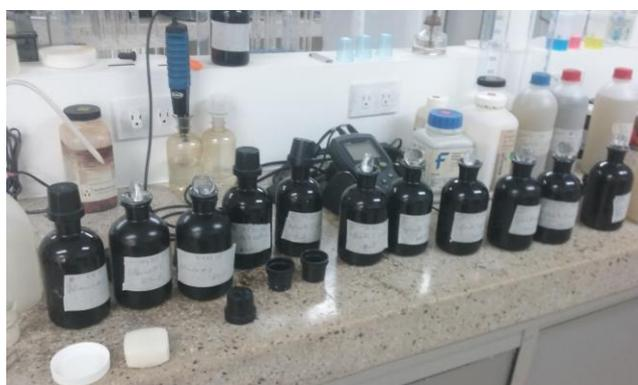
**Fotografía 44** Se mezclan las diluciones en ml indicadas por cada muestra, incluyendo los 4 blancos con la mezcla de agua destilada y los 4 reactivos hasta el borde del frasco ámbar.
