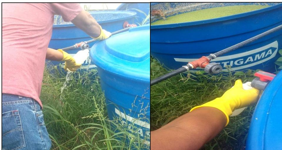
**Fotografía 96 Recolección de muestras en el efluente del Tanque Homogeneizador.**
