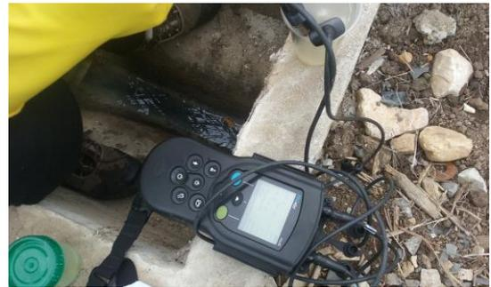
**Fotografía 14 Resultados de pH, conductividad, STD y temperatura en el equipo HQ40d de la muestra del Afluente del Tanque Séptico**
