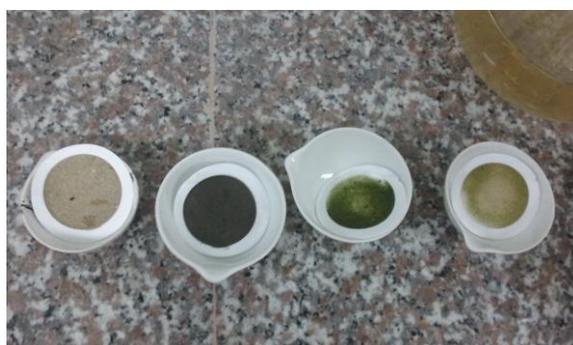
**Fotografía 58 Se procede a retirarlas en una hora, se pesan en la balanza y se reingresan en el horno y así sucesivamente hasta que el peso sea constante.**
