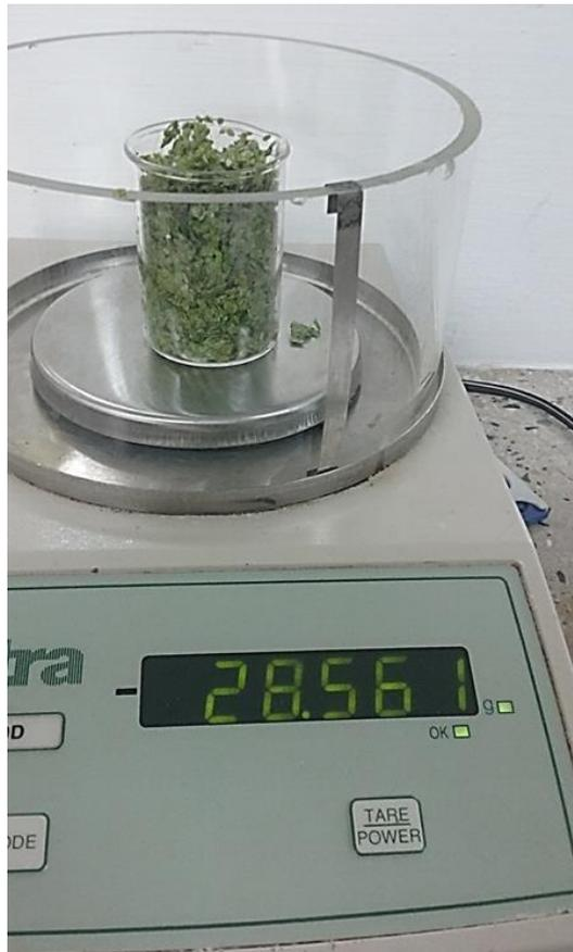
**Fotografía 111 Pesaje de la lenteja de agua en una balanza analítica.**
