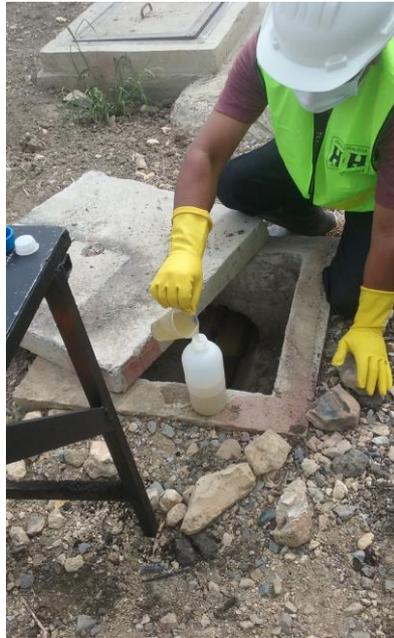
**Fotografía 6 Recogiendo las muestras en un envase sellado en el Afluente del Tanque Séptico**
