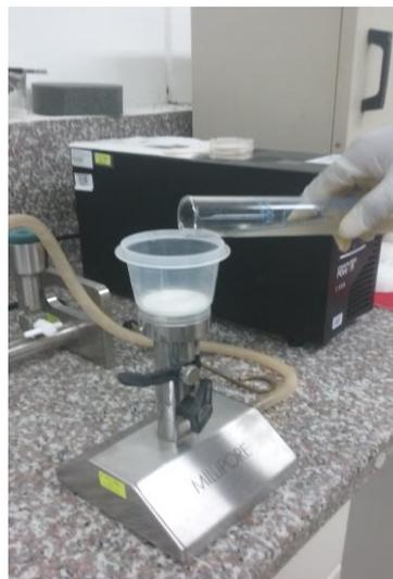
**Fotografía 55** Filtrando la muestra en este caso 50 ml de M1 en la máquina Millipore .
