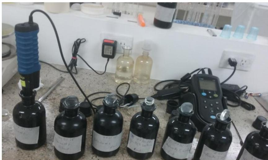
**Fotografía 45** Listas las botellas se coloca el sensor LBOD 10101 en cada una de ellas durante 10 segundos y se mide el Oxígeno disuelto inicial con el equipo HQ40d y se procede a llevar a la incubadora de DBO durante 5 días.
