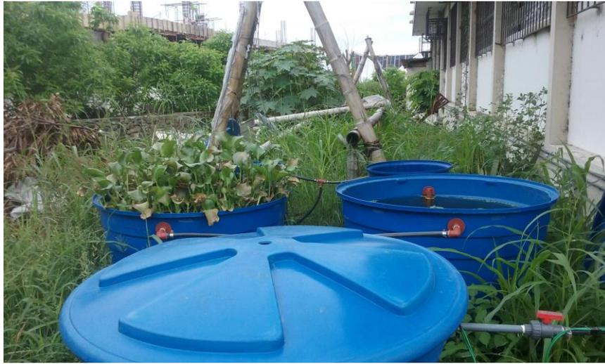
**Fotografía 87 Planta piloto con la Lechuga de Agua colocada.**
