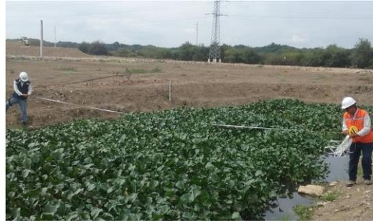
**Fotografía 27 Medición en campo de la geometría de la Laguna 1.**
