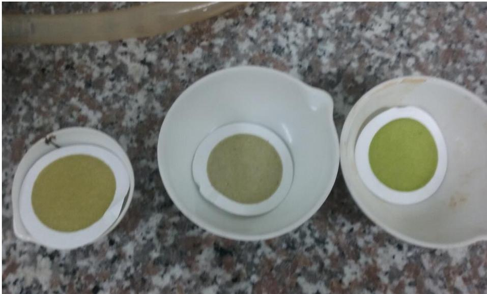
**Fotografía 103** Ensayo de SST a las muestras de 24 de febrero del 2018 de la planta piloto de la UCSG.
