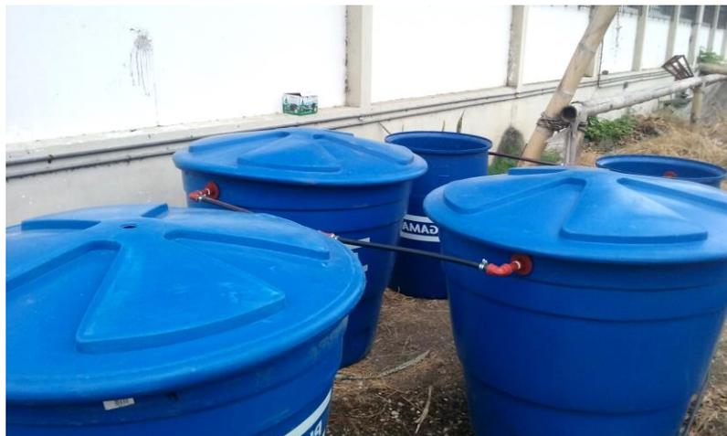
**Fotografía 77 Planta piloto instalada (5 tanques Plastigama: 3 de 500 litros de capacidad y los 2 finales de 250 litros de capacidad).**
