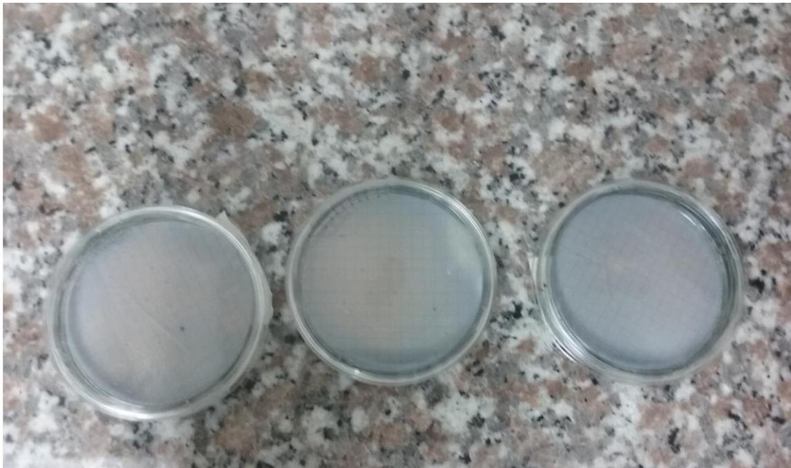
**Fotografía 106 Resultados del ensayo de Coliformes Fecales de las muestras del 24-02-18 de la planta piloto de la UCSG.**
