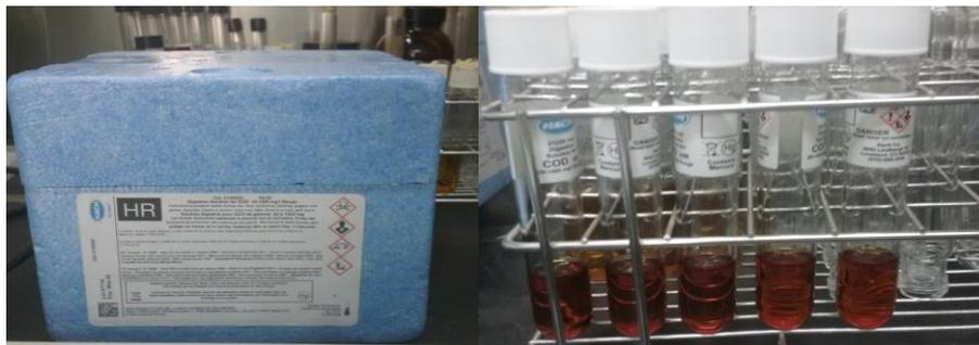
**Fotografía 48 Viales de Reactivos con medios preparados de DQO con rango de 20-1500 mg/l.**
