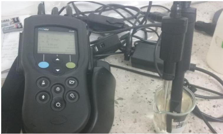
**Fotografía 101 A las tres muestras se les realizó el ensayo de pH, conductividad, STD, temperatura.**
