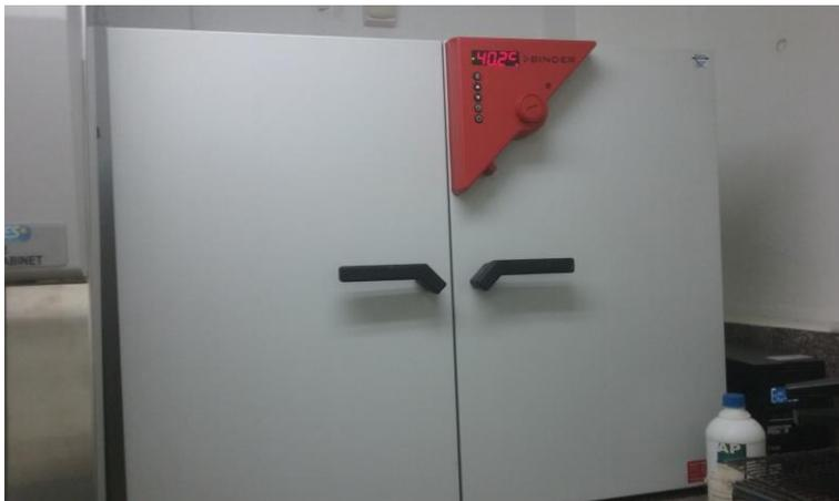
Fotografía 69 Finalmente, se colocan las Cajas Petri con las Millipore filtradas por 24 horas en la incubadora.
