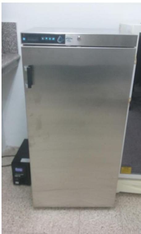
**Fotografía 46** Incubadora de DBO a 5 días a 20°C, después de los 5 días se repite el proceso de calcular el Oxígeno disuelto final y se procede a calcular el DBO en cada muestra.
