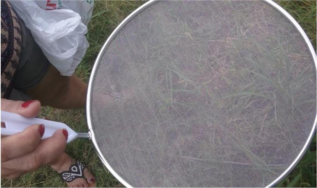
**Fotografía 107 cedazo metálico con mango rotatorio de 10 pulgadas de diámetro.**
