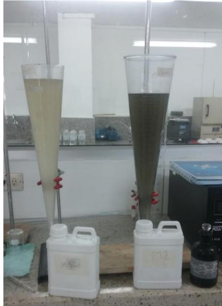
Fotografía 59 Se coloca cada una de las muestras en el Cono Sedimentador en donde se espera un lapso de tiempo y se observan los ml de sedimentos que se han decantado.
