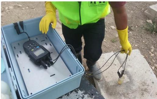
**Fotografía 7 Realizando el ensayo directo de pH, conductividad, sólidos totales disueltos y temperatura en el equipo multi-parámetro HQ40d, en el instante de tomar la muestra respectiva.**
