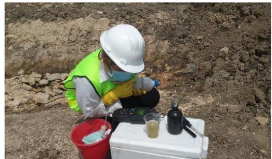
**Fotografía 16 Escribiendo la etiqueta de cada muestra recogida para identificarla en el Laboratorio de Aguas de la UCSG y proceder a ensayarlas.**
