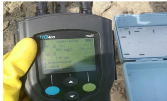
**Fotografía 8 Pantalla del equipo HQ40d en donde se muestran los resultados característicos directos de las distintas muestras como por ejemplo: pH, conductividad, temperatura y STD.**
