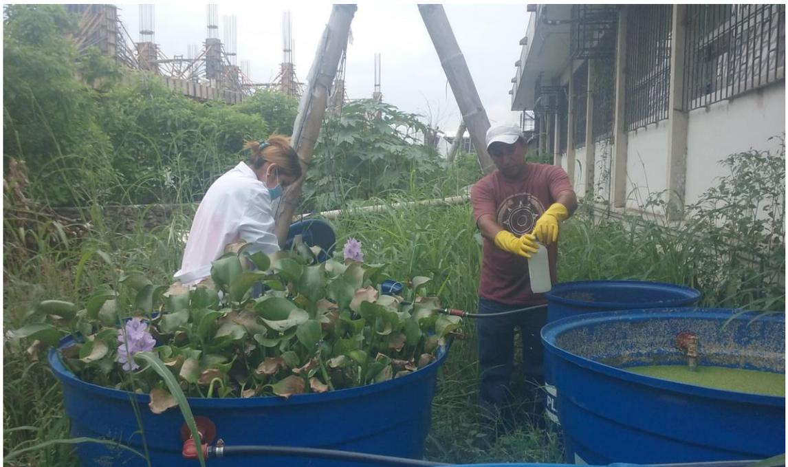
**Fotografía 99 Recolección de las muestras en los efluentes del Tanque con Lechuga de Agua y del efluente del Tanque con Lenteja de Agua.**
