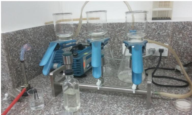
Fotografía 68 Una vez filtradas las diluciones de muestra y agua peptonada en su exponencia se colocan las millipore en las cajas Petri con el reactivo.
