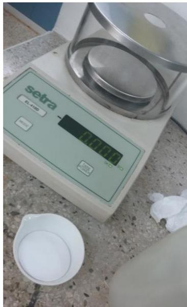
**Fotografía 52** Se coloca el filtro de fibra de vidrio en una capsula numerada para poder identificarla.
