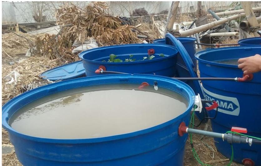
**Fotografía 85 Recirculando el Agua Residual con una segunda bomba ubicada en el tanque homogeneizador que envía el flujo constante al sistema.**
