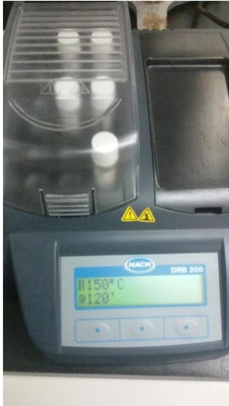
Fotografía 50 Una vez homogénea la mezcla se ingresan los viales al digestor durante 2 horas y se procede a analizarlo en un equipo en el que nos da los resultados en mg/l.
