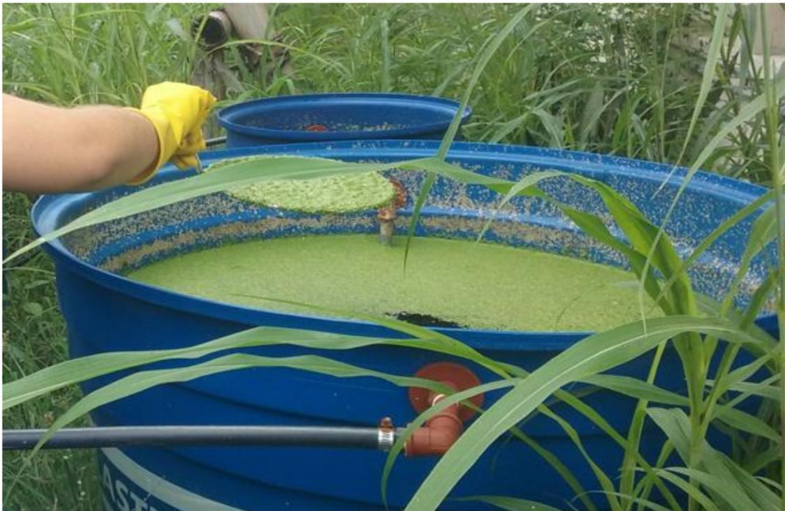
**Fotografía 108 Recolección de lenteja de agua con cedazo de metal en el tanque de la planta piloto.**
