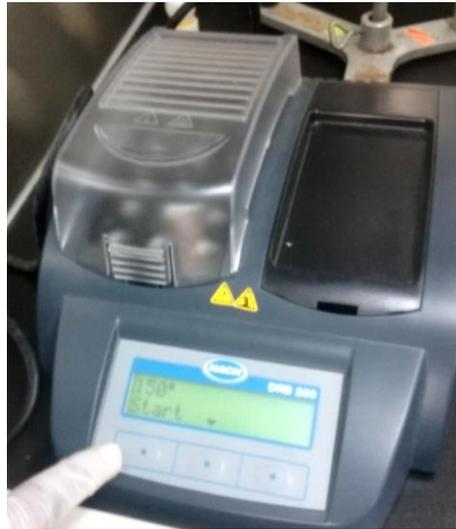
**Fotografía 47 Aparato Digestor DQO a una Temperatura de 150°C para el ensayo**
