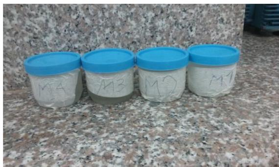
**Fotografía 64** Se tienen previamente las muestras a analizar ambientadas de 20 °C- 25°C aproximadamente.
