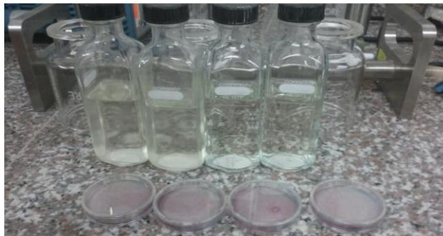
**Fotografía 66** Se diluyen las muestras en la solución de agua peptonada hasta la exponencia designada y en las cajas Petri se agrega el reactivo.
