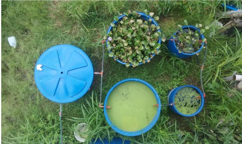
**Ilustración 23** Vista aérea de la planta piloto instalada en la parte posterior del edificio de la Carrera de Ingeniería en Sistemas, en donde se reflejan los dos tipos de plantas acuáticas simulando que se encuentran en lagunas de oxidación totalmente y parcialmente cubiertas sus superficies de plantas acuáticas flotantes. Todo este sistema empieza con el primer tanque que es homogeneizador que almacena el AARRDD para que asegure un flujo constante y continuo.
