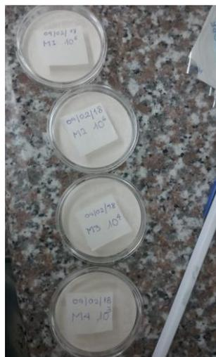
**Fotografía 67** Cajas Petri con su Millipore y su etiqueta respectiva indicando la exponencia específica en coliformes.
