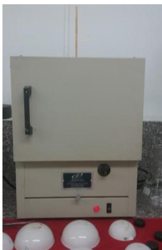
**Fotografía 57 Se colocan las cápsulas con los filtros de vidrio y las muestras filtradas en un horno de 103 °C - 105°C .**
