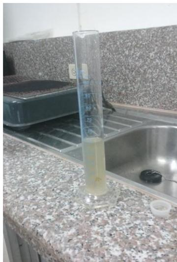
**Fotografía 54** Se colocan los ml previamente designados para cada muestra en una probeta para procederlos a filtrar.
