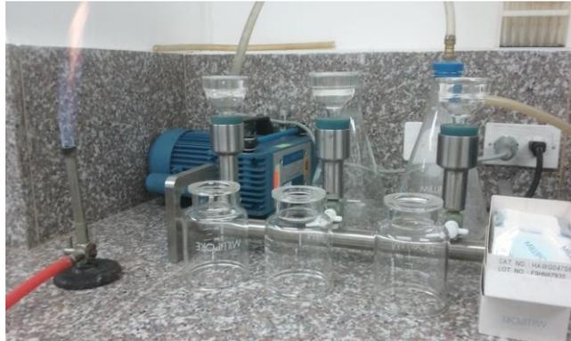
**Fotografía 65** Se enciende el equipo de filtración con el mechero y esterilizan los demás utensilios necesarios.
