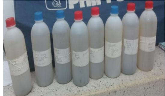
**Fotografía 12 Dos envases de muestras de agua residual por cada punto de análisis (M1, M2, M3 y M4) refrigeradas para su preservación.**
