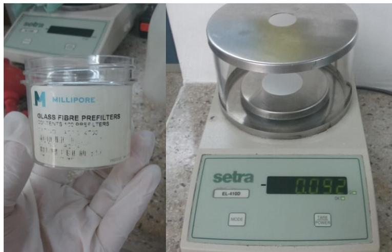
Fotografía 51 Se proceden a pesar los filtros de fibra de vidrio necesarios para las muestras obtenidas en una balanza analítica.
