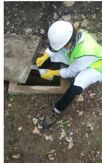
**Fotografía 21 3er Muestreo en el Afluente del Tanque Séptico, realizado con las debidas precauciones para evitar desbalances en los resultados de los ensayos.**
