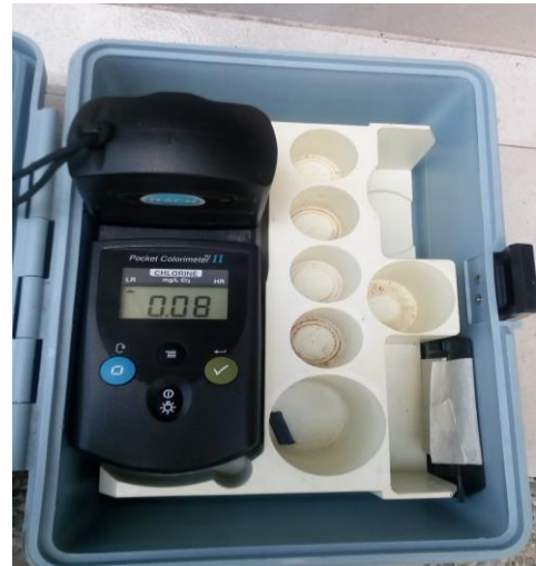
Fotografía 12. Cantidad de Cloro antes de la Cisterna del Bloque D1.
