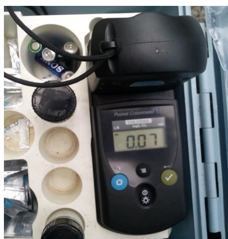
Fotografía 42. Cantidad de Cloro que ingresa al Bloque C3
