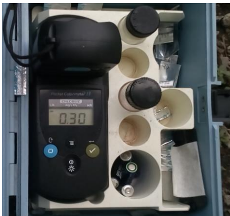
Fotografía 35. Cantidad de Cloro que ingresa a la Cisterna del Bloque 3.
