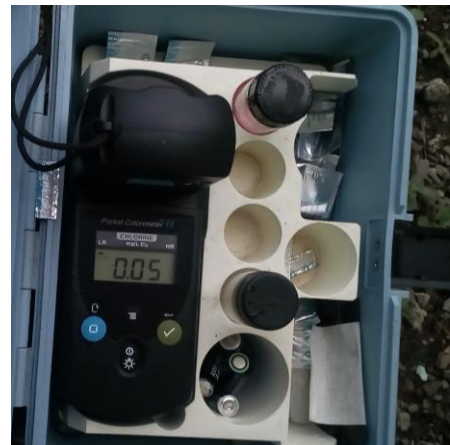
Fotografía 36. Cantidad de Cloro después de la Cisterna del Bloque 3.
