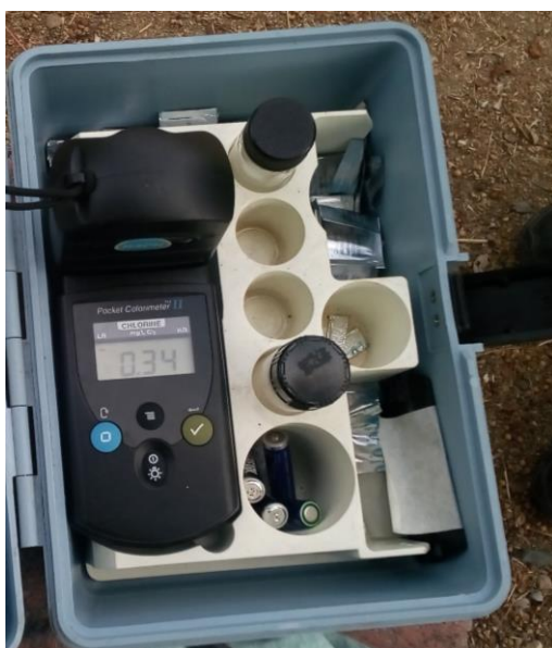
Fotografía 31 Cantidad de Cloro que ingresa al Bloque C4.
