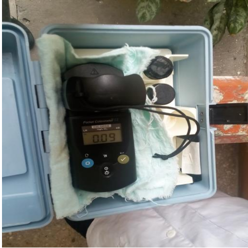
Fotografía 5. Cantidad de Cloro del Bloque C7, después de la Cisterna.
