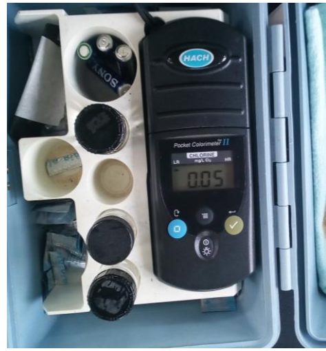
Fotografía 18. Cantidad de Cloro después de la Cisterna del Bloque A5.
