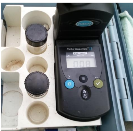
Fotografía 67. Cantidad de Cloro que ingresa a la cisterna del Bloque 5.
