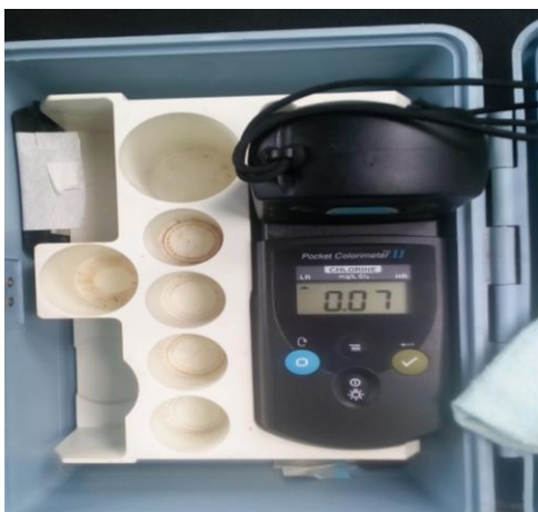
Fotografía 15. Cantidad de Cloro después de la Cisterna Colegio Francisco de Orellana.
