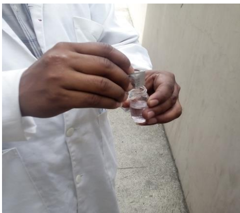
Fotografía 9. Disolución del reactivo DPD en la muestra del Bloque F2
