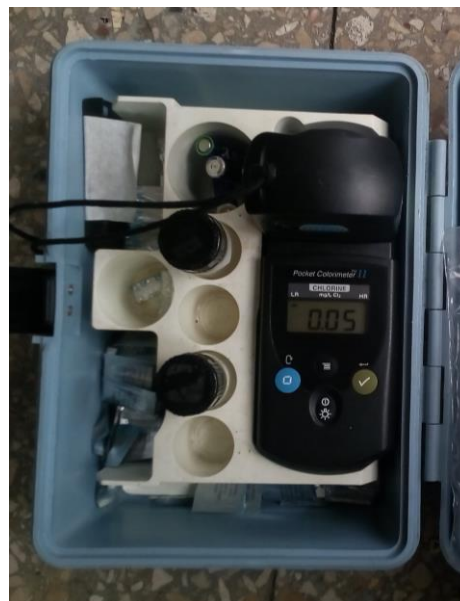
Fotografía 32 Cantidad de Cloro que ingresa a la Cisterna del Bloque C4.
