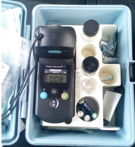
Fotografía 17. Cantidad de Cloro que ingresa a la Cisterna del Bloque A5.
