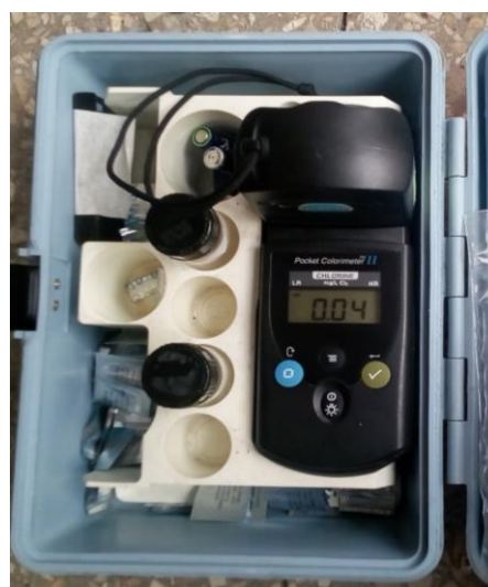
Fotografía 30. Cantidad de Cloro que ingresa al Bloque C1.
