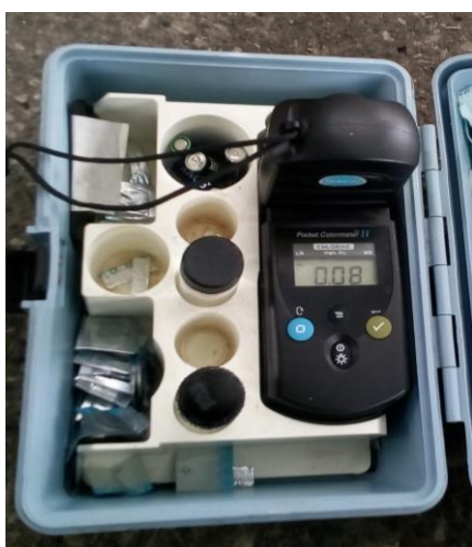
Fotografía 41. Cantidad de Cloro que ingresa a la Cisterna del Bloque 3.
