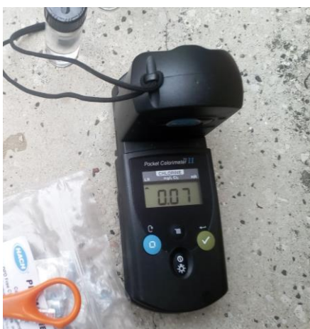
Fotografía 71. Cloro en Cisterna Escuela Fiscal N70 Presidente Velasco.
