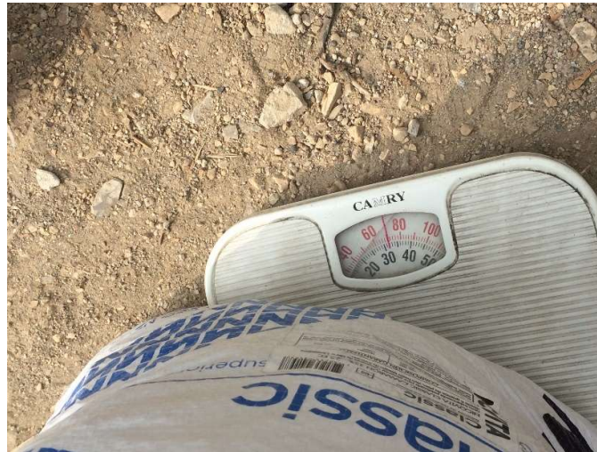
Ilustración 53: Registro del peso de los residuos de bloques de hormigón en la balanza
