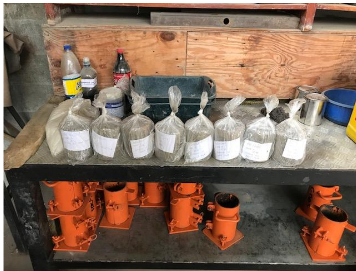
FIGURA 7.- COLOCACIÓN DE LAS BRIQUETAS EN FUNDAS PLÁSTICAS
