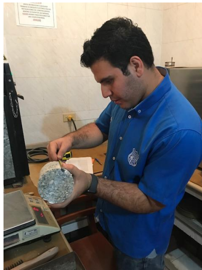
FIGURA 22.- TOMA DE MEDIDA DE LA ALTURA DE LA BRIQUETA A ENSAYAR
