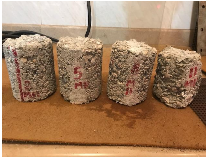
FIGURA 34.- BRIQUETAS #2 CEMENTO MH DESPUÉS DE 12 CICLOS
