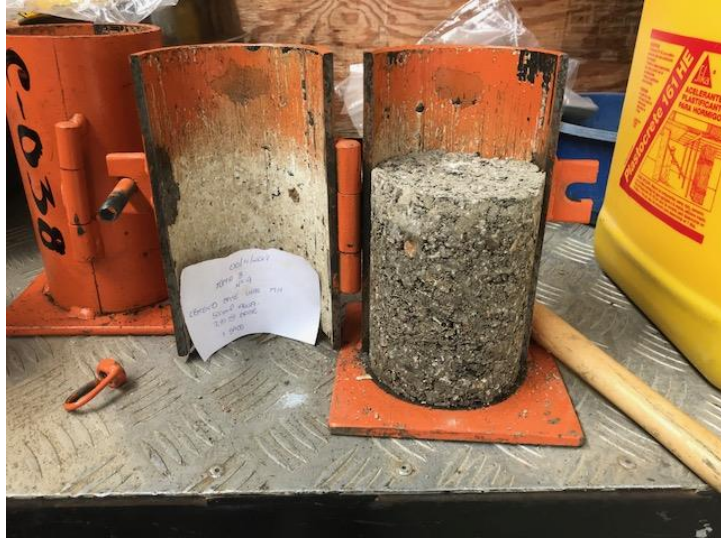
FIGURA 6.- DESENCOFRADO DE LAS BRIQUETAS SUELO-CEMENTO
