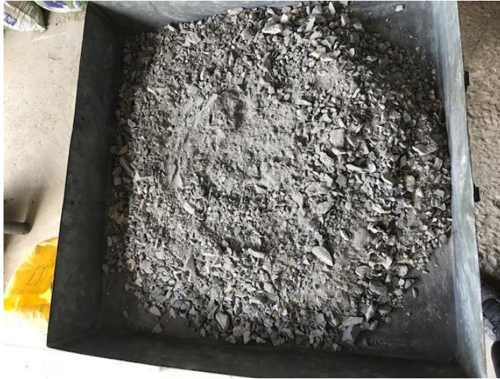
FIGURA 3.- MEZCLA DE MATERIAL BASE Y CEMENTO
