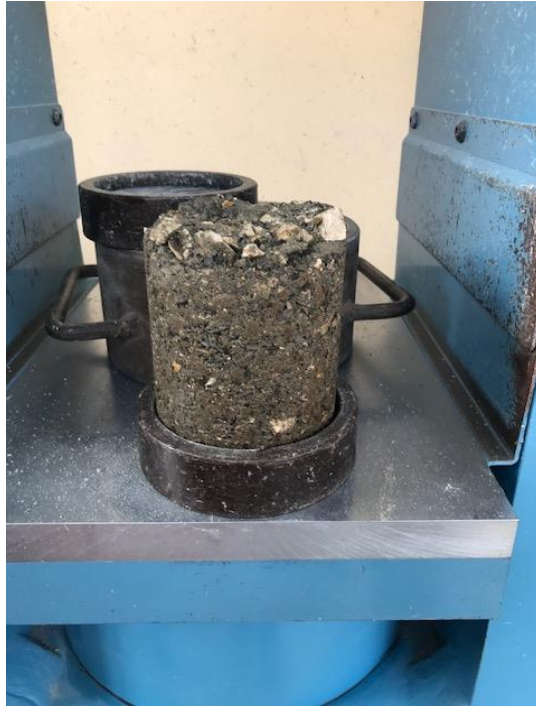
FIGURA 11.- BRIQUETA DE SUELO-CEMENTO SATURADA PARA EL ENSAYO
