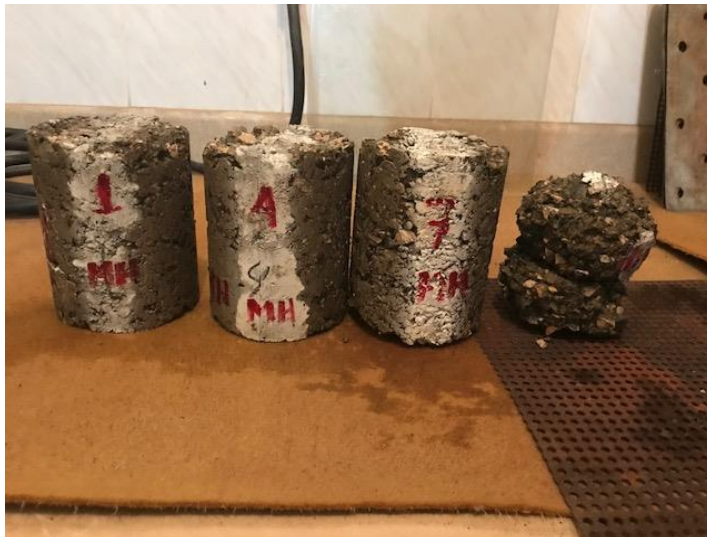
FIGURA 33.- BRIQUETAS #1 DE CEMENTO MH DESPUÉS DE 12 CICLOS
