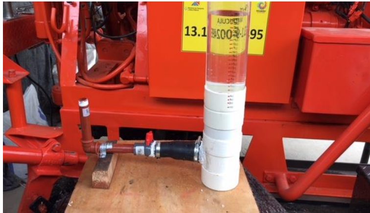
Figura 15.- Equipo para ensayo de permeabilidad
