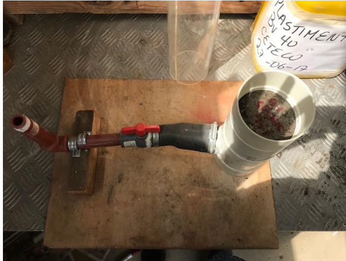
FIGURA 17.- ACOPLAMIENTO DE LA BRIQUETA SUELO-CEMENTO EN EL PERMEÁMETRO
