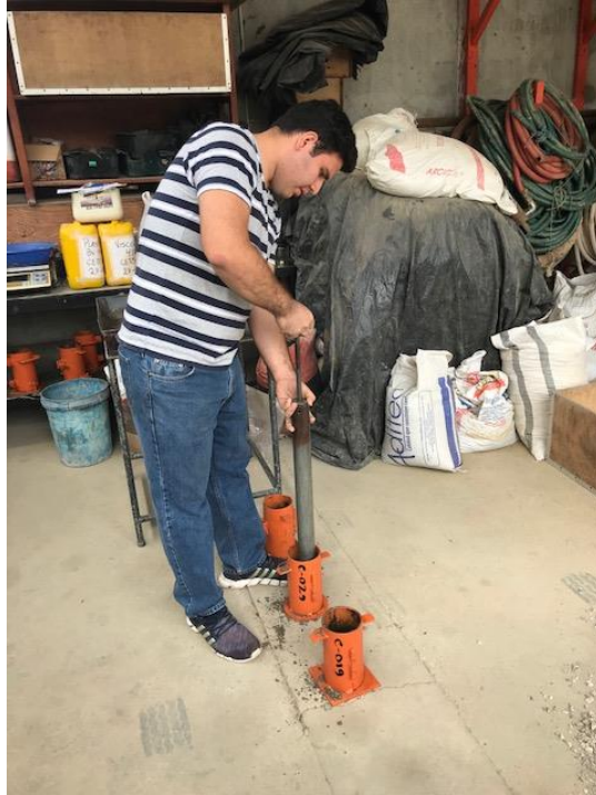
FIGURA 5.- ELABORACIÓN DE LAS BRIQUETAS SUELO-CEMENTO
