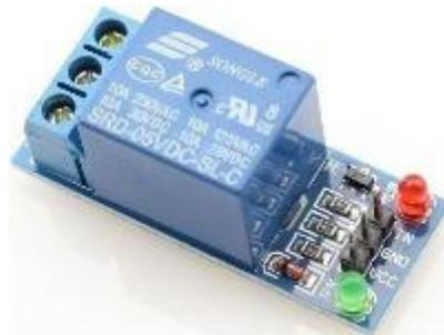
**Figura 18.** Relé 1 canal. Recuperado de <http://www.cvrelectronic.com/descripcion.php?id=106>
