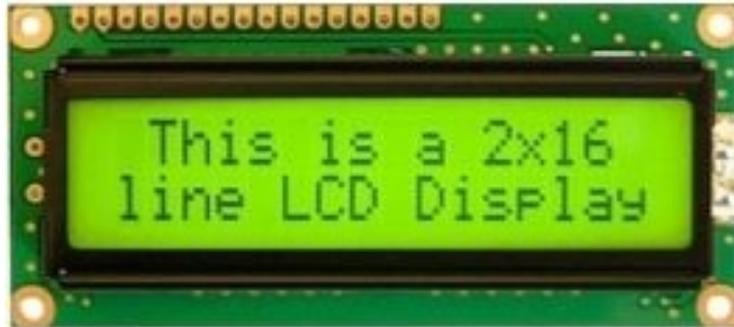
**Figura 24.** *Display LCD 2x16.* Recuperado de <http://www.electronicoscaldas.com/displays-lcd-alfanumericos-y-graficos/130-display-lcd-16x2-backlight-verde.html>
