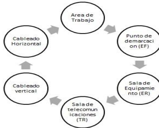
Figura 7. Subsistemas de cableado estructurado.
