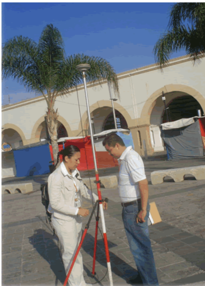
Figura 6. Usuarios instalando un receptor de señal GPS. (“Sistema de Posicionamiento Global (GPS)”, 2014)
